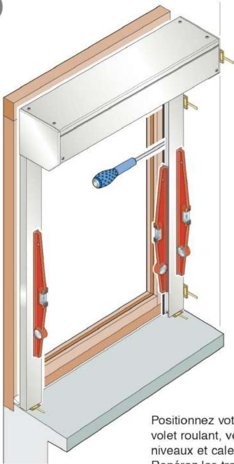
Positionnez votre bloc volet roulant, vérifiez les niveaux et calez si besoin. Repérez les trous de fixation.
